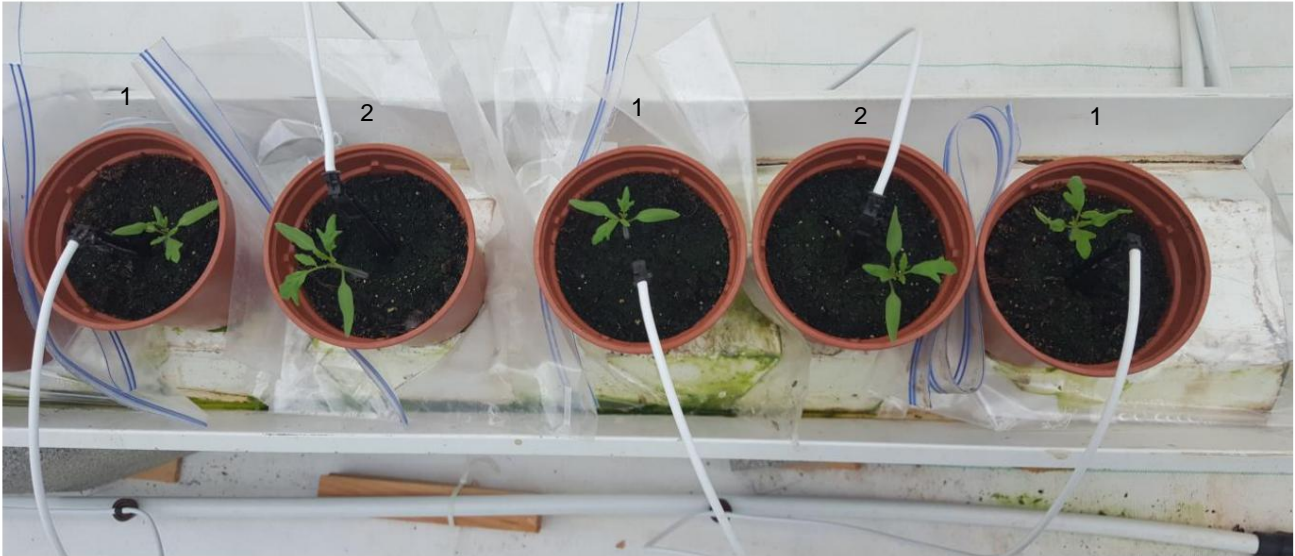
Figura 3: Piantine di pomodoro fecondate con una soluzione dotata dell'agente anticalcare Drag'Eau (1) e senza questa attrezzatura (2). I sacchetti di plastica impediscono che le due soluzioni si mescolino nella grondaia.
